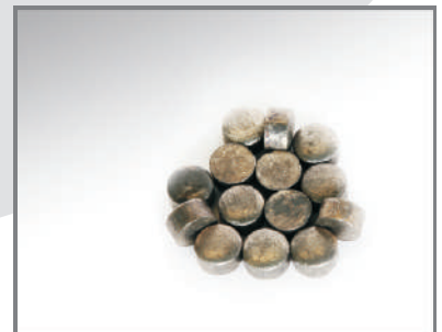
Piombo in pastiglie da Gr.5 di elevata purezza per analisi di metalli preziosi tramite coppellazione.
