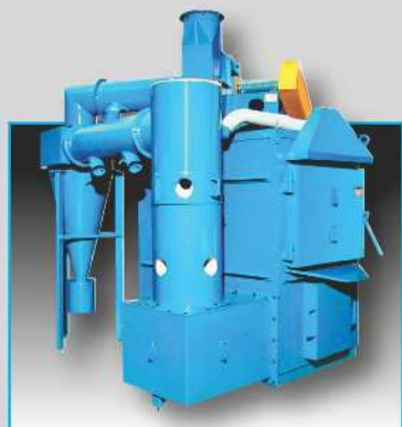
vista da sx - cicloni/left side cyclones view
